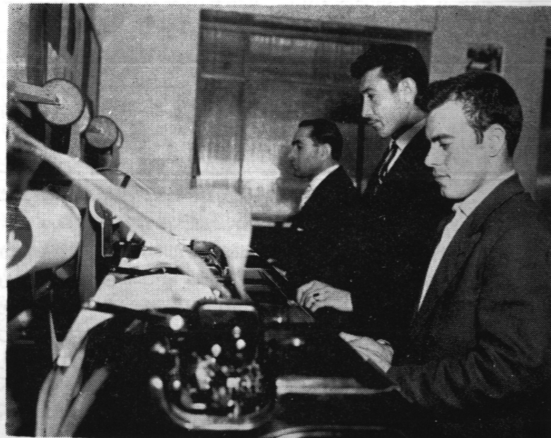
در اداره هواشناسی مهرآباد - دستگاههای رادیو تله تایپ، هوای ایران را بکلید کشورها مخابره نموده و مرتباً هوای سایر کشورها را دریافت مینمایند.
